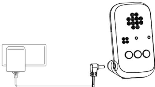
Branchez la fiche DC (courant continu) de l'adaptateur secteur sur la prise DC sur le côté de l'unité parents et branchez l'autre côté de l'adaptateur secteur sur une prise de courant.
